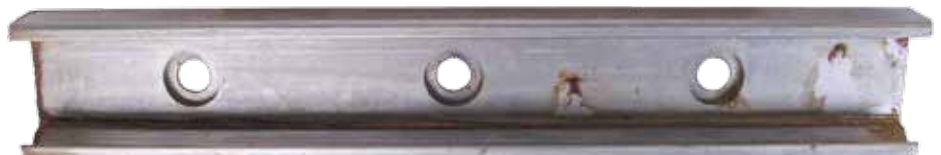
Chemische Vernickelung nach 360 Stunden
