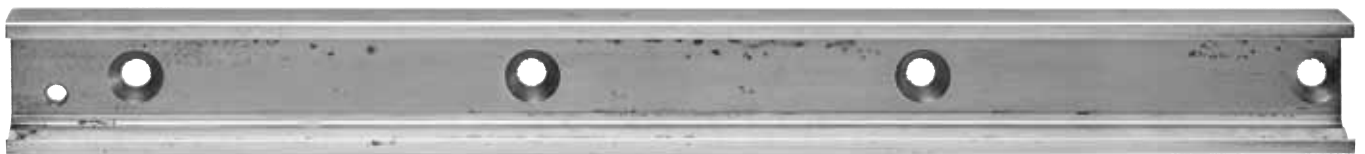
Beschichtung Rollon Alloy nach 720 Stunden
